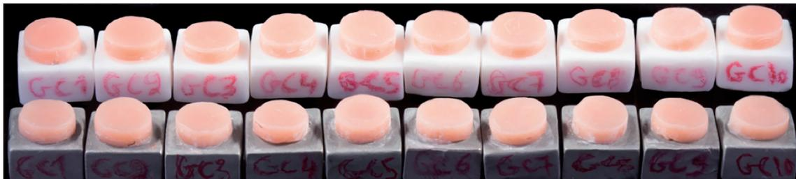
Fig. 2: Gradia® gum shades collée aux échantillons en Cr-Co et en Zr.
