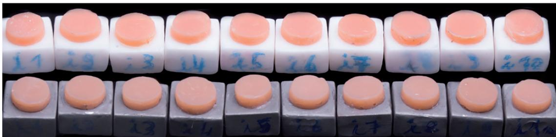
Fig. 1: SR Nexco® collée aux échantillons en Cr-Co et en Zr.
